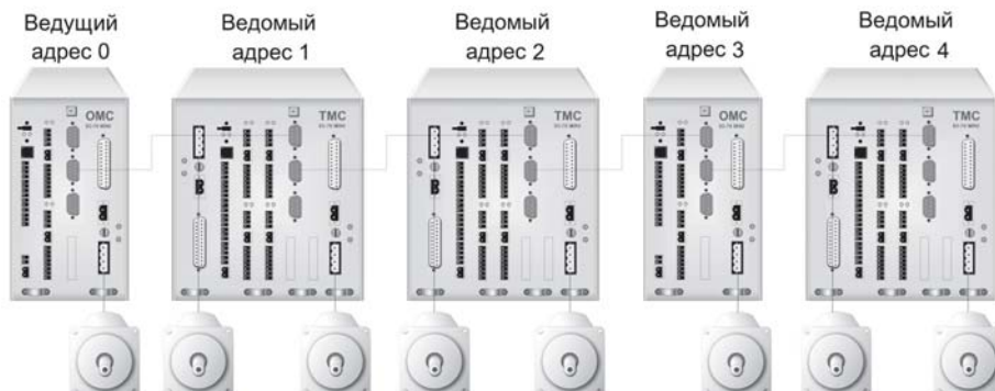
РИС. 4. ▼ Стандартное решение по объединению в сеть независимо работающих двигателей
