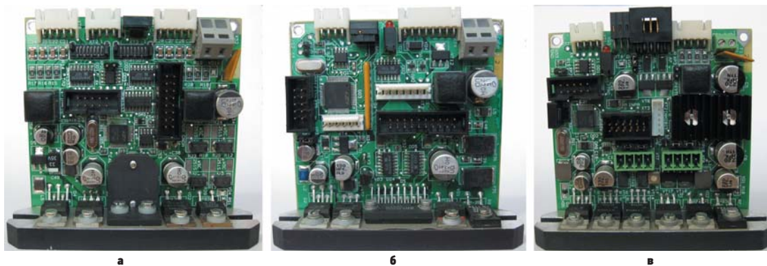
РИС. 2. ◀ Линейка контроллеров сетевых систем управления: а) MSCD-64D — контроллер микрошаговый двухфазный двухосный; б) MSCD-256 — контроллер микрошаговый двухфазный; в) CSTL-035 — контроллер периферийных устройств
