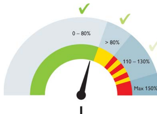
РИС. 1. ▲ Состояние индикатора канала СВМ в зависимости от значения тока в цепи нагрузки: зеленый — нормальный режим работы; желтый — сигнал о превышении 80% от установленного значения тока; желтый/красный — перегрузка; красный — короткое замыкание
