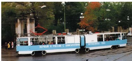
РИС. 1. ▼ Первый в России трамвай с двигателем переменного тока
