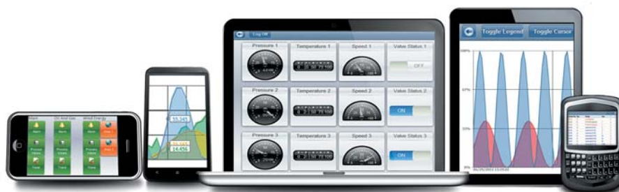
РИС. 1. ▼ Современные пакеты SCADA позволяют работникам контролировать удаленные участки и управлять ими при помощи планшетов и смартфонов
