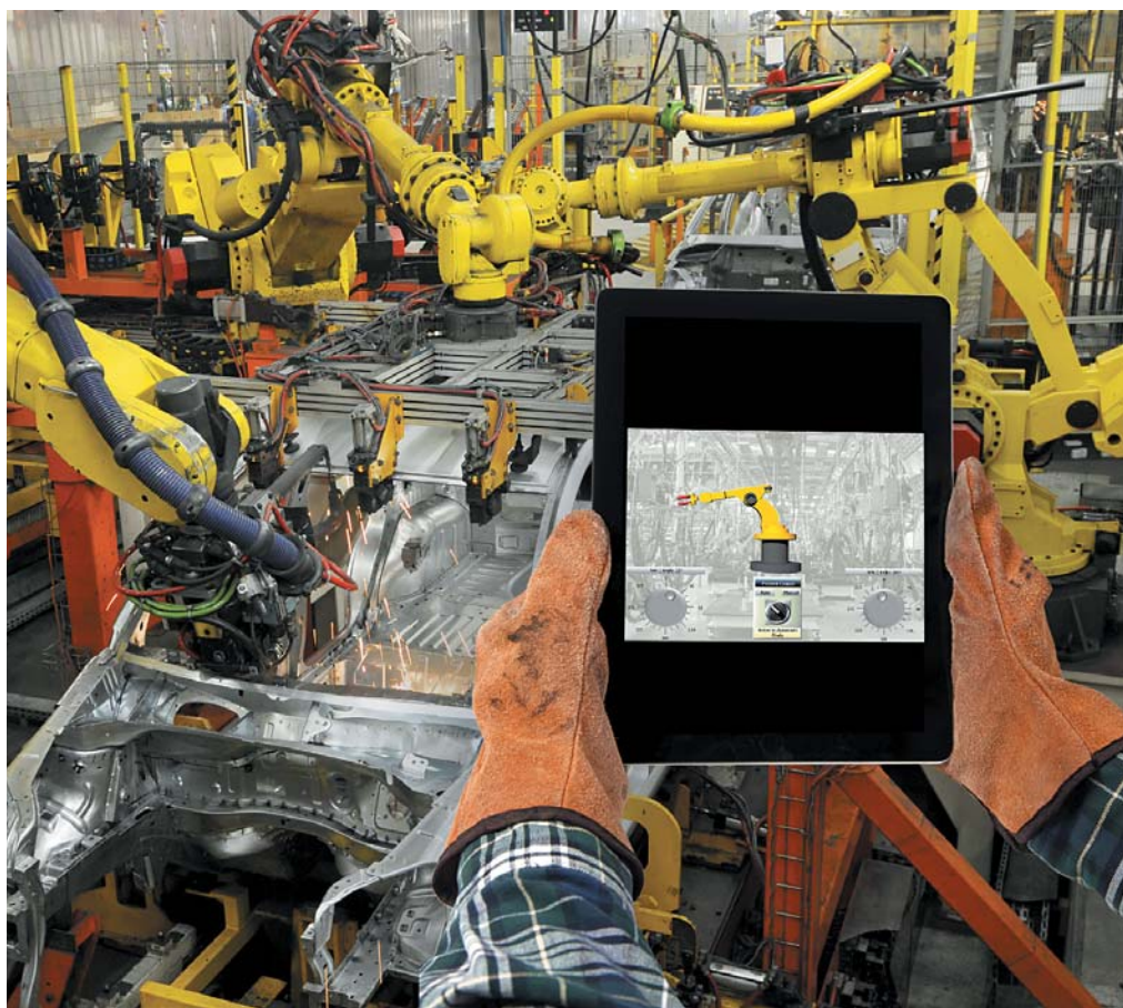
РИС. 3. ▼ Системы SCADA, доступ к которым осуществляется при помощи многоточечных сенсорных экранов, лучше подходят для жестких условий эксплуатации, чем другие интерфейсы, такие как клавиатура и мышь
