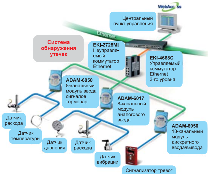
РИС. 3. ► Система мониторинга нефтепроводов (обнаружение утечек)
