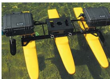
РИС. 6. ▶ «Работ на воде» Kingfisher M100 с бортовым компьютером fit-PC2
