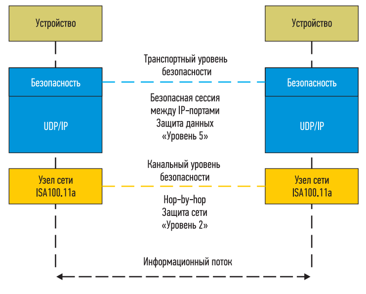
Рис. 1. Обеспечение безопасности беспроводных коммуникаций по ISA 100
