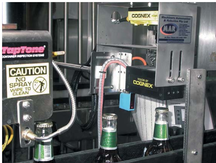
РИС. 6. ◀ Контроль наличия и положения пробки бутылки
