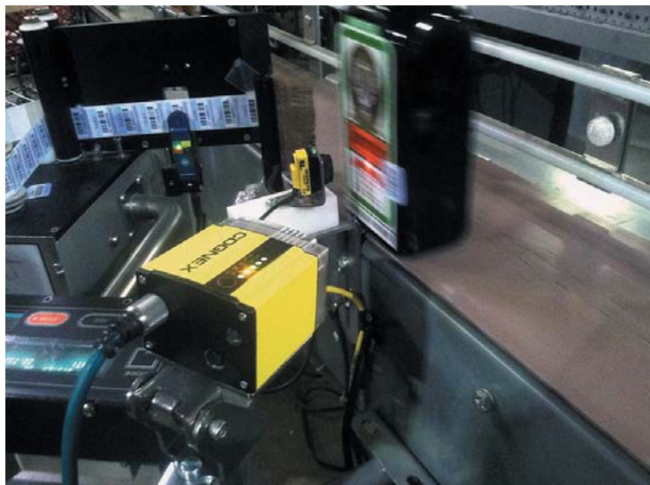
РИС. 9. ► Считывание кодов на акцизной марке
