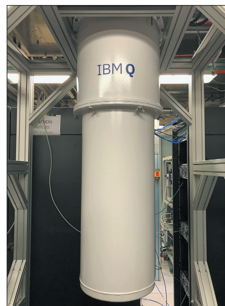
Рис. 2. Внешний вид квантового процессора IBM, размещенного внутри криогенной установки Oxford Triton dilution refrigerator
