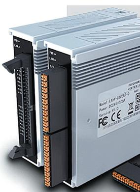
с питанием от постоянного напряжения 24 В и LX3VP-1616-M-T-4H-A от сети переменного тока 85–265 В. Микрокомпьютеры этой серии имеют 4 высокоскоростных импульсных входа на 200 кГц и транзисторную коммутацию выходов. Ethernet поддерживается только через BD-модуль расширения ETH-BD.
