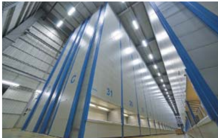
РИС. 4. ◀ Автоматизированные лифтовые склады Kardex Shuttle XP
