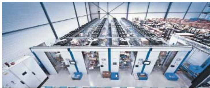
РИС. 3. ◀ Автоматические карусельные системы горизонтального типа Kardex Horizontal
