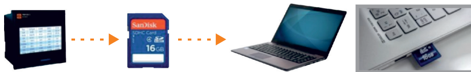
РИС. 6. Использование SD-карты для хранения данных МИ120.5
