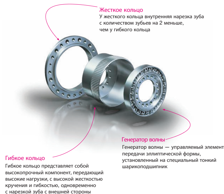
РИС. 3. Схематическое изображение конструкции волновой передачи
