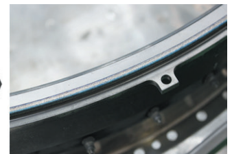
РИС. 5. ▲ Восстановление бандажного обода турбовентиляторного двигателя F110
