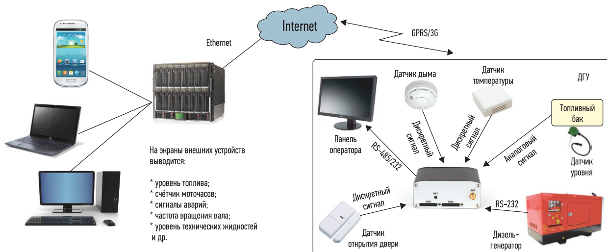
Рис. 4. ▼ Схема подключения 3G-терминала «Позитрон М 3G USB исп. Е4»
