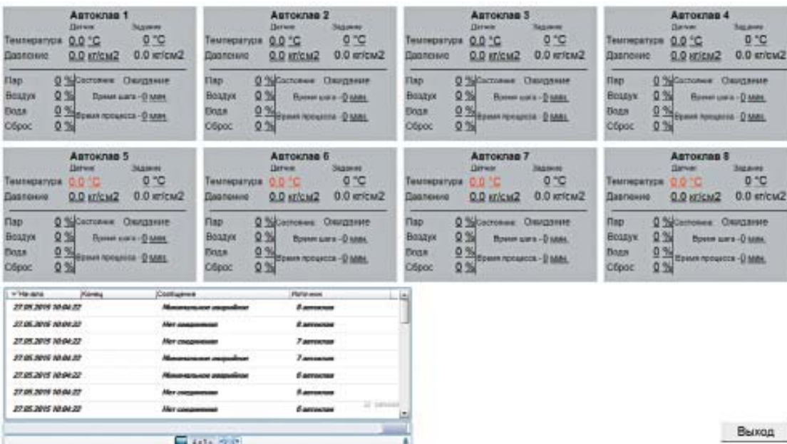
РИС. 4. ◀ Экранная форма контроля в автоклавах на рабочем месте оператора (АРМ)
