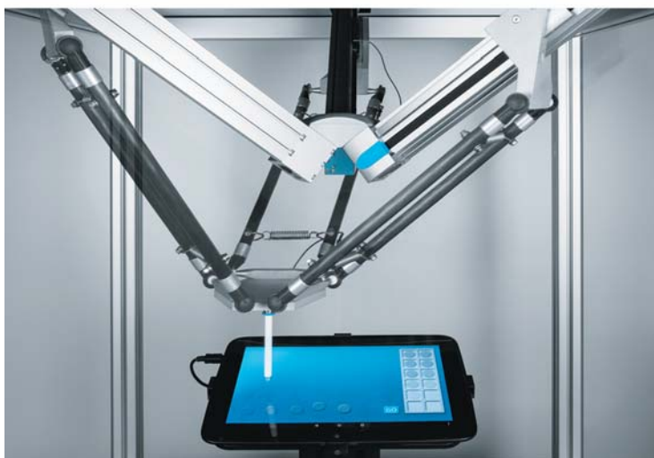
РИС. 6. ▲ Использование EMCA в качестве сервопривода для мини-Трипода без шкафа управления
