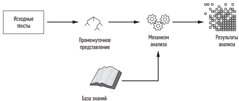
РИС. 2. ▼ Структура статического анализатора
