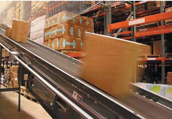
РИС. 4. ▲ Коробки, движущиеся по шпунтовому конвейеру
