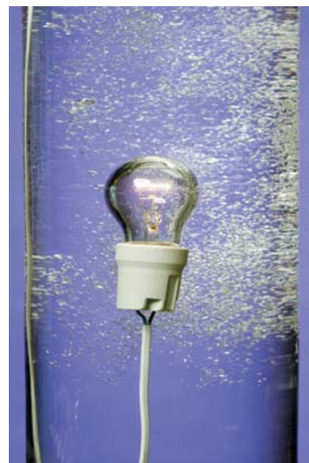
РИС. 3. ► 3A Novec 1230 не проводит электричество
