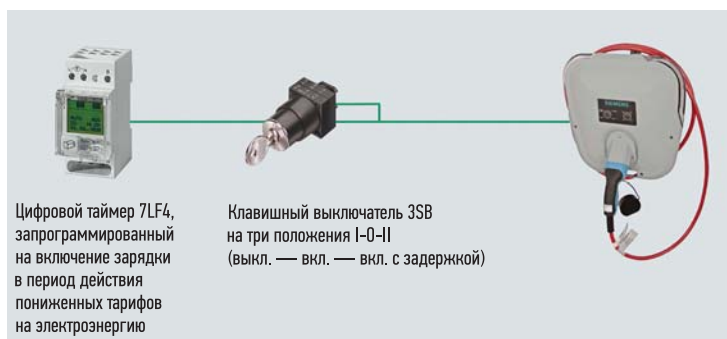
РИС. 2. ◀ Если схема зарядки не слишком сложна, отсрочка начала зарядки по таймеру может быть эффективным решением
