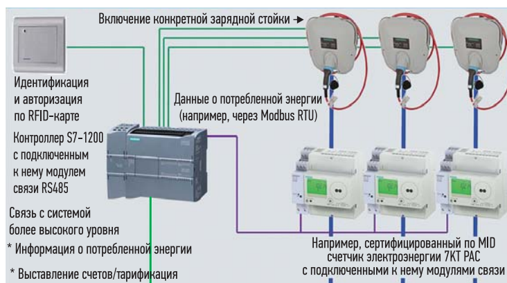
РИС. 4. ▶ Индивидуальные контроллеры в каждом зарядном устройстве позволяют отслеживать энергопотребление каждого устройства и оптимизировать график эксплуатации и зарядки
