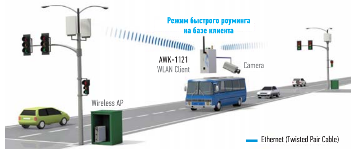
РИС. 4. ◀ Пример построения беспроводной сети и видеонаблюдения в общественном транспорте в режиме быстрого роуминга
